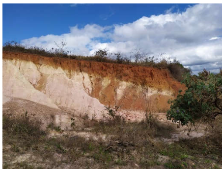
Figura 2- Corte onde se observa os dois horizontes de solo amostrados nas proximidades da Agência Chevrolet em João Monlevade (MG)
